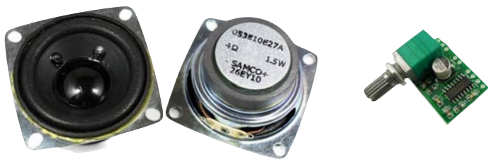
直径50mmのスピーカーユニット 3W+3Wのデジタルアンプ基板
