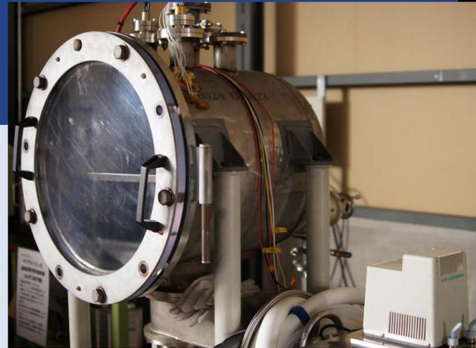
槽内の空気を抜いて宇宙環境に近い真空状態を作り出すことができる実験装置です。2006年に植松電機が製作に関わった超小型人工衛星の開発の中で、真空の宇宙空間でも正常に動作することを確認するために社内で製作しました。この装置により、特殊な宇宙用部品ではなく、一般に入手可能な材料や部品でも宇宙で正しく機能することを確認し、人工衛星の開発コストを大幅に削減することができました。
